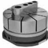
MNG'ye monteli Alüminyum pens vasıtasıyla bağlanmış iş parçası
